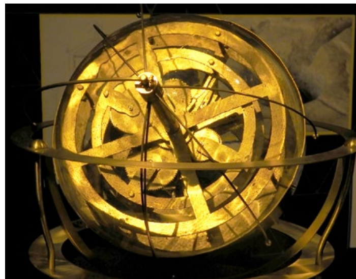
Die Sphaera. Nachbau einer Planetenmaschine des griechischen Mathematikers und Physikers Archimedes
